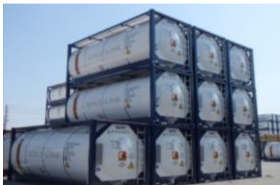
Figure 4.7 – LNG ISO containers.
